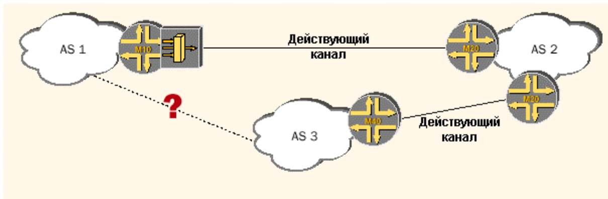
Рисунок 4. Выборка и регистрация пакетов. Поставщик услуг AS1 может использовать выборку для анализа трафика, который он отправляет на AS3 через AS2. Если объем трафика слишком велик для AS3, может оказаться оправданным прямой канал пиринга с AS3.
